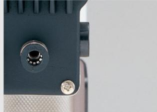
通过向电机内供给干净的空气，可防止溶剂和酸性气体的侵入，保证电机内部不受腐蚀。
