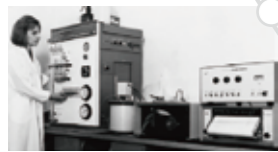
034-0004型 日立最初的流动型液相色谱仪
