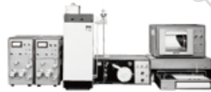
635型 日立串联双柱塞高效液相色谱仪
