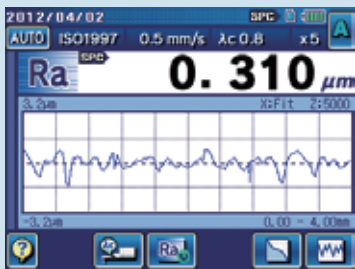
轮廓显示：一个参数的测量结果和测量轮廓
